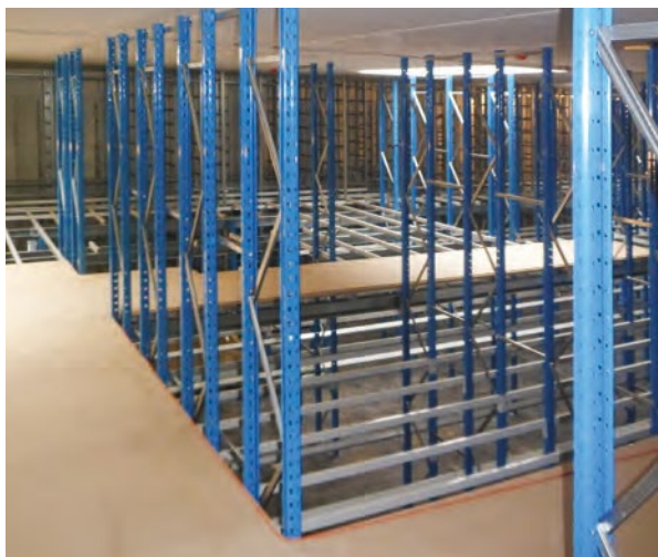
Entrepôt de stockage de pneumatiques d'un concessionnaire automobile sur sol et 2 étages, pour permettre l'entreposage d'un maximum de références pour toutes les saisons (Marc Van Ackere)
