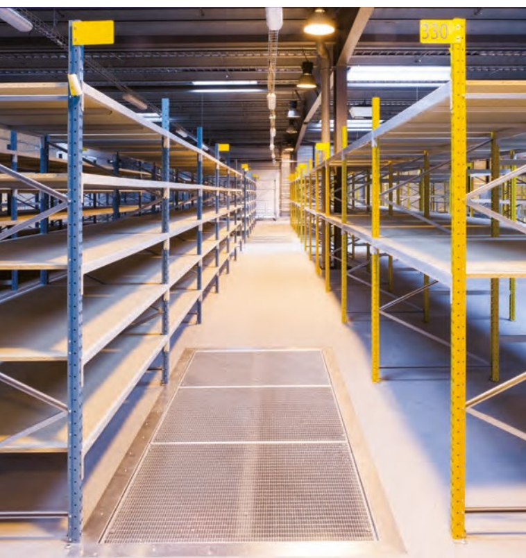
Implantation de rayonnages personnalisés par un affichage numérique et des coloris différents, pour une identification rapide et efficace des zones de stock des pièces détachées
