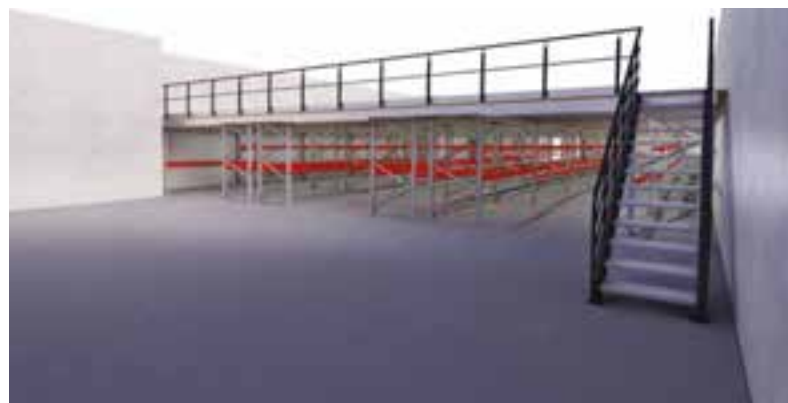
Projet d'installation avec calcul précis du raccord entre le plancher posé sur des rayonnages ACTI-RACK et la structure de la mezzanine autoporteuse. Convient également avec des planchers en béton pour permettre un accès direct des bureaux au stock situé à l'étage
