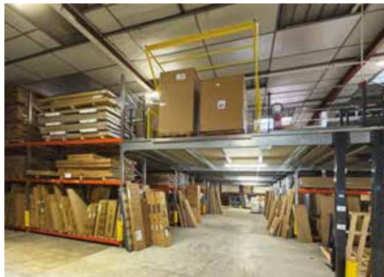
Zones d'enlèvement d'un magasin de meubles et d'un magasin d'électroménager, conçues avec une combinaison de racks à palettes et de mezzanines pour répondre aux exigences normatives, à l'encombrement et au poids des charges stockées ou manutentionnées (Avas Equipement)
